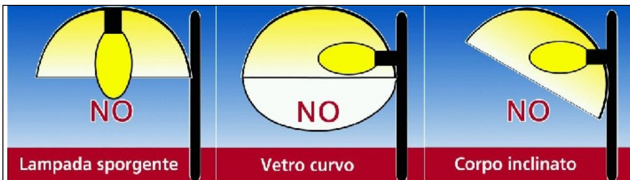
Figura 2.1 – Tipologie di apparecchi non ammessi (cortesia: CieloBuio)
