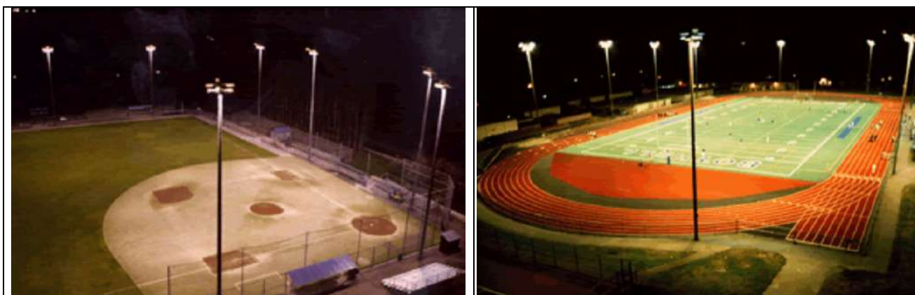
Figura 3.280 – Impianti sportivi di grandi dimensioni realizzati con proiettori asimmetrici installati orizzontali e nello specifico: Campo di calcio con pista di atletica e impianto di Baseball.
