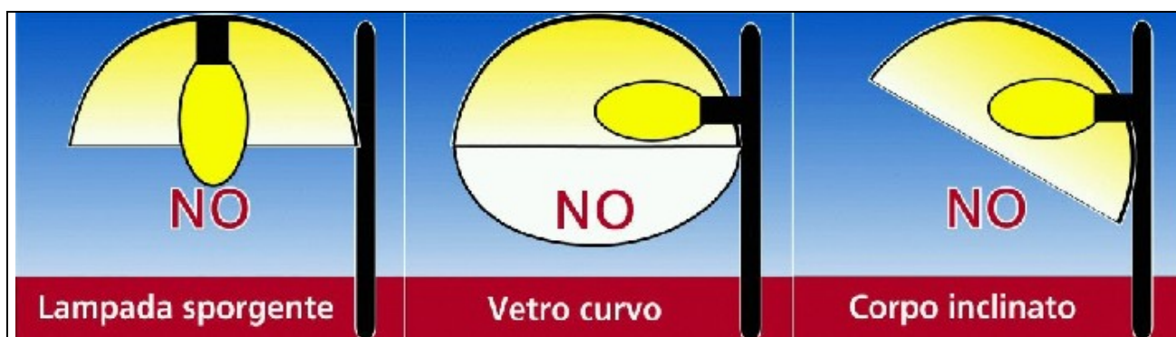
Figura 2.1 – Tipologie di apparecchi non ammessi (cortesia: CieloBuio)
