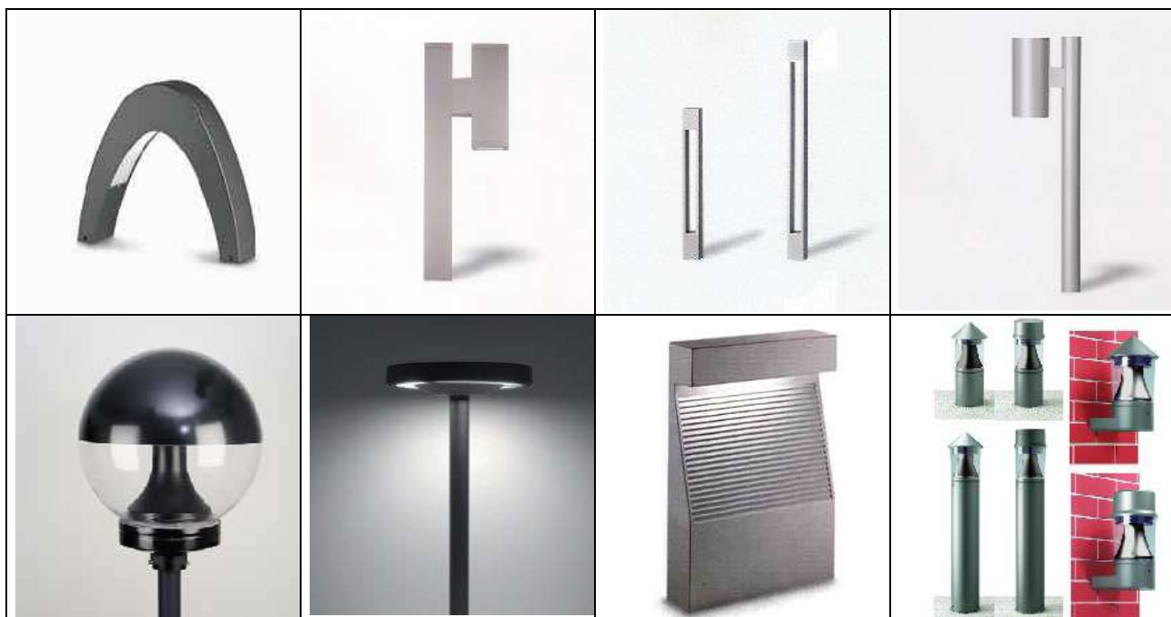
Fig. 3.120 – Apparecchi con emissione nulla verso l'alto per installazione in giardini e vialetti. Attenzione che la tipologia a sfera (a sinistra in basso) esiste in pochissimi modelli conformi alla legge regionale; tutte le altre versioni se dotate di sorgente con meno di 1500lm possono rientrare nelle deroghe di legge ma solo dopo attente verifiche.
