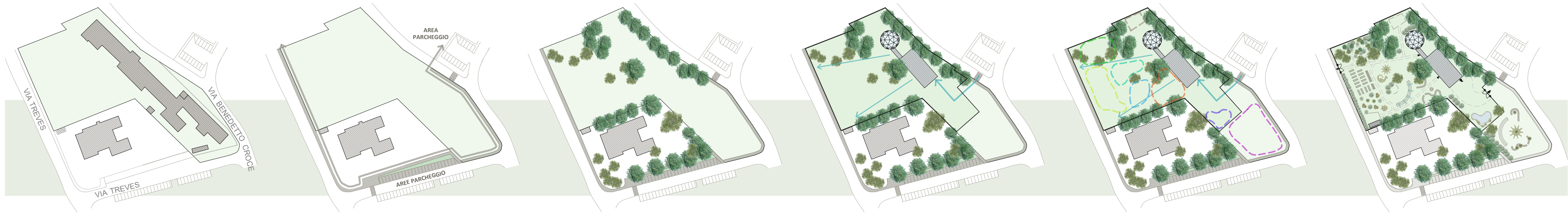
Stato attuale Demolizione edificio ex "Fateci Spazio" Mantenimento e valorizzazione alberi ed arbusti esistenti Realizzazione di un padiglione polifunzionale e di una serra a cupola Suddivisione in Aule all'aperto con differenti indirizzi. Stato di Progetto
