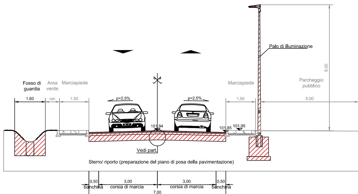
SEZIONE TIPO RAMPA MONOSENTO
