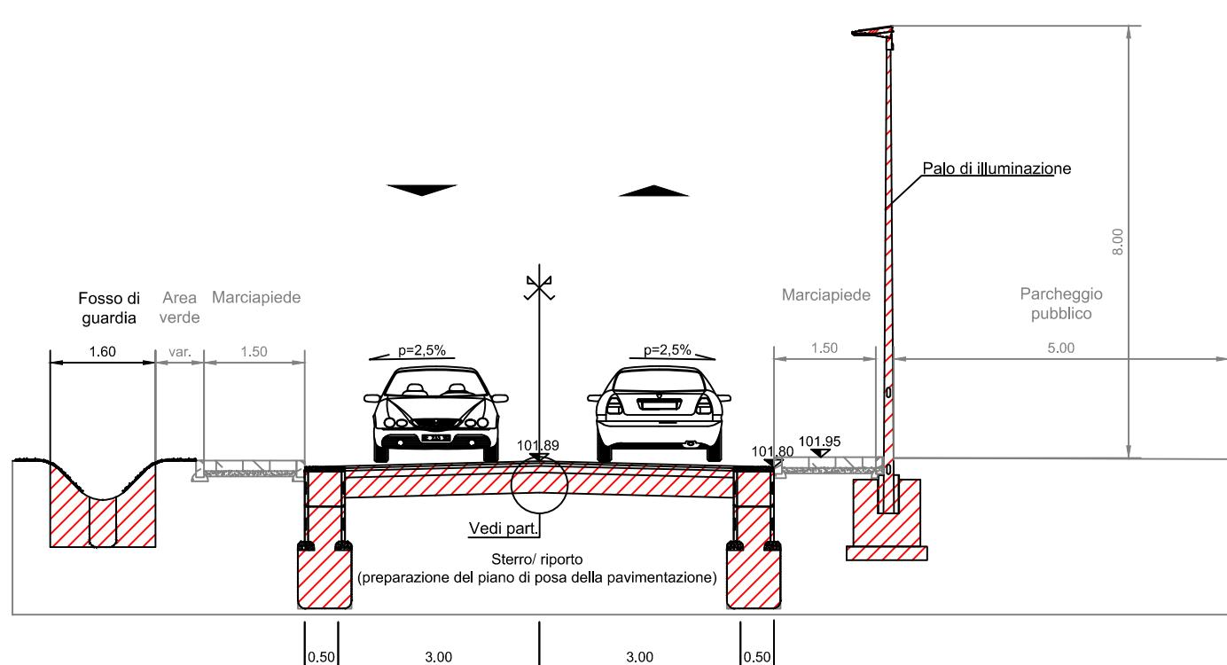
SEZIONE TIPO RAMPA MONOSENTO CON AIUOLA SPARTITRAFFICO
