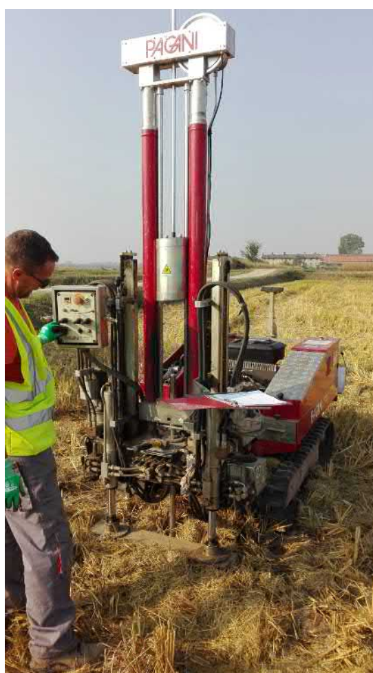
Esecuzione indagini penetrometriche
